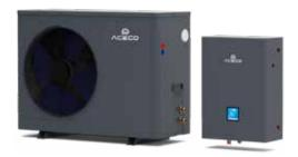
La aerotermia Beta-2 es un sistema de climatización tipo split, que se caracteriza por tener una unidad exterior e interior separadas. La unidad exterior extrae el calor del aire exterior, mientras que la unidad interior distribuye el calor o la refrigeración en el interior del edificio. Este modelo utiliza el refrigerante R32 y permite alcanzar una temperatura máxima de salida de agua de 60 °C.
